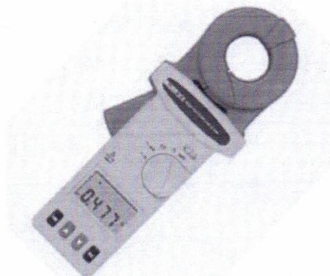
Figura 2-Alicate Terrômetro utilizado
